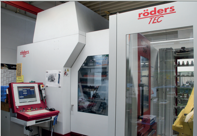
Auch über Nacht: Die EMSBH-ATH-Mikrobohrer verrichten rund um die Uhr ihren Dienst auf der automatisierten 5-achsigen Rödgers RXP600DSH © Moldino
